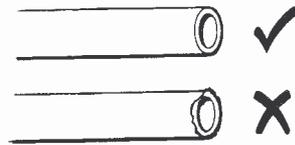
Rohre so gerade wie möglich absägen, es dürfen keinerlei scharfe Kanten mehr am Rohr sein, die den Gummiring verletzen könnten.
