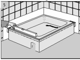
6. Wanne einsetzen. Ablaufgarnitur ausrichten und an die Wanne anschliessen.
