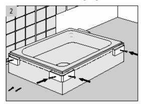
1. Ablaufgarnitur an die Ablaufleitung anschliessen und ausrichten. Wannenträger vorpositionieren, Aussparungen für Kontrollloch sowie für Ablaufleitung ausschneiden.
