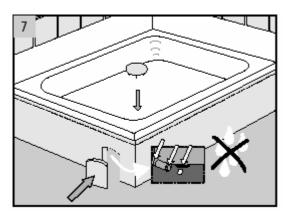
8. Wanne im Wannenträger fugengerecht ausrichten und dann zur korrekten Auflage kurz belasten. Unebenheiten im Wannenrandbereich können mit Montageschaum ausgeglichen werden.
