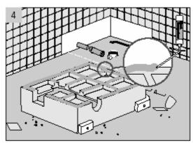
5. Wannenträger am Montageort positionieren und exakt waagrecht ausrichten. Position Wannenträger nach ca. 5 Minuten nochmals überprüfen.
