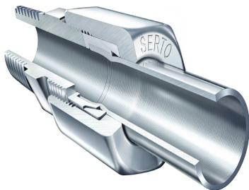
Verschraubungsmutter mit einem Gabelschlüssel richtig anziehen. Mit einem Rollgabelschlüssel entgegen ziehen damit das Rohr sich nicht verformt. Für die Kontrolle die Verbindung komplett lösen und die Verformung kontrollieren, an der Rohrinnenseite muss eine deutliche Wulst sichtbar sein.
