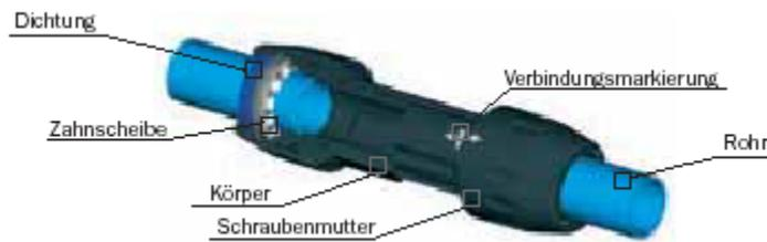
**Rohr bis zur Verbindungsmarkierung in den Adapter einsetzen. Die Zahnscheibe des Verbinders wird dann gespannt, und die Verbindung ist fertig.**
