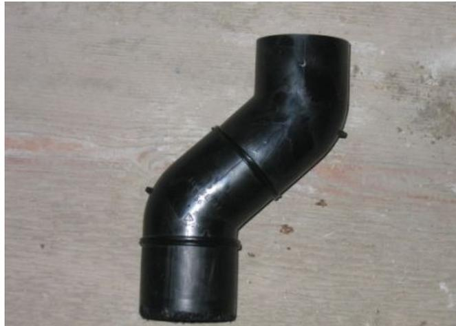
Dann wird gemessen wie hoch der Ablauf kommt. Er kommt meistens auf 43 cm, wir mussten aber noch den Unterlagsboden dazurechnen, etwa +16 cm. Danach wird ausgerechnet wie viel Rohr noch bis Mitte obere Steckmuffe dazwischen kommt.
