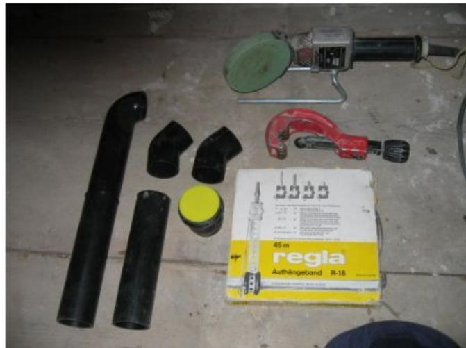
Als erstes werden die beiden 45° Bögen zusammenschweisst. Am unteren Ende wird ein Rest Rohr angespiegelt und dann auf 4.5 cm eingekürzt, also die Stecktiefe der Muffe.
