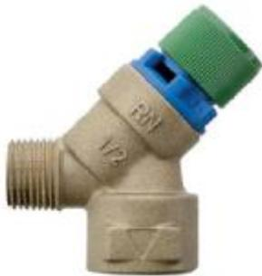
Das Sicherheitsventil kann man auch reinigen indem man einfach das Oberteil abschraubt. Mit einer kleinen Drahtbürste den Sitz reinigen und das Oberteil wieder draufschauben. Der Einstelldruck bleibt danach unverändert. Schon ganz wenig schmutz auf dem Sitz oder der Dichtung, kann das Sicherheitsventil zum rünnen bringen.
